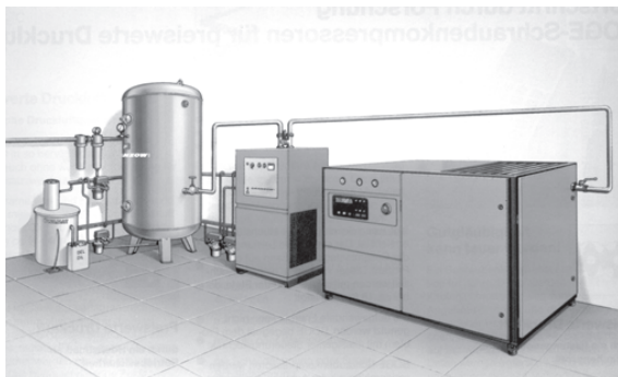
Fig. 8.8 : Kompressoranlæg med skruekompressor trykluftbeholder, trykluft køletørrer og filter system
