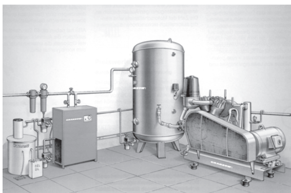
Fig. 8.6 : Trykluftanlæg med stempelkompressor, trykluft- beholder, trykluft køletørrer og et filtersystem
